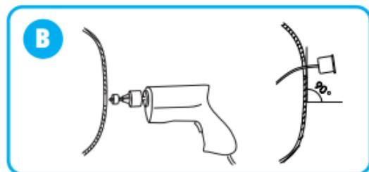
Les capteurs doivent au minimum avoir un axe parallèle au sol, soit  $90^\circ$ , selon la perpendiculaire du pare-chocs (voir schéma **B**, ci-dessus).
