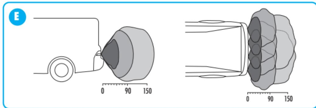
Les capteurs ultrasons ont un signal et un champ d'action comme défini sur le schéma **E**.
